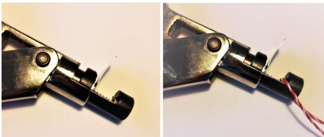
Placering af rulleplombe i plombetang
